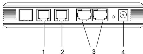
1. Разъём подключения телефона (RJ11)
