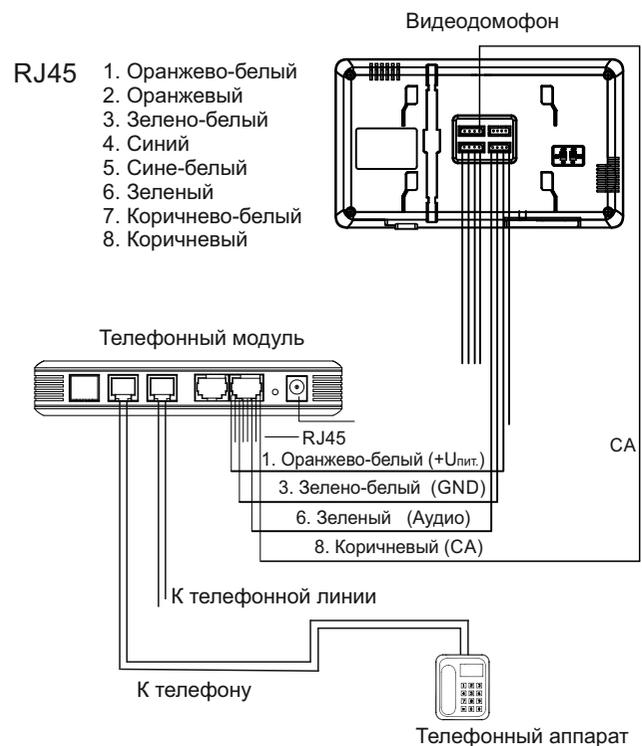
\* Гнезда под разъемы Rj45 для подключения вызывных панелей, запараллелены, и используются для удобства подключения. Например, к первому гнезду подключается вызывная панель, а ко второму гнезду подключается домофон.
